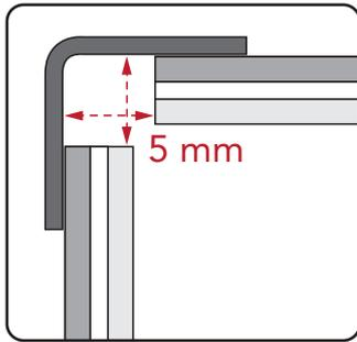
Si vous souhaitez effectuer des angles extérieurs ou intérieurs à l'aide des éléments de finition neowood UltraProtect®, il est nécessaire de laisser un espace de 5 mm à chaque extrémité.
