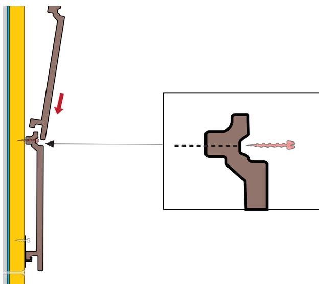
Le diamètre des vis étant de 4mm, nous recommandons un pré-perçage avec des forets bois de 5mm. Un pré-perçage d'un diamètre plus large permettra la dilatation de la lame.
