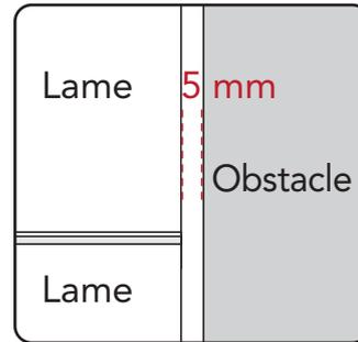
Toujours laisser un espace de 5mm entre les lames et les obstacles (mur par exemple).
