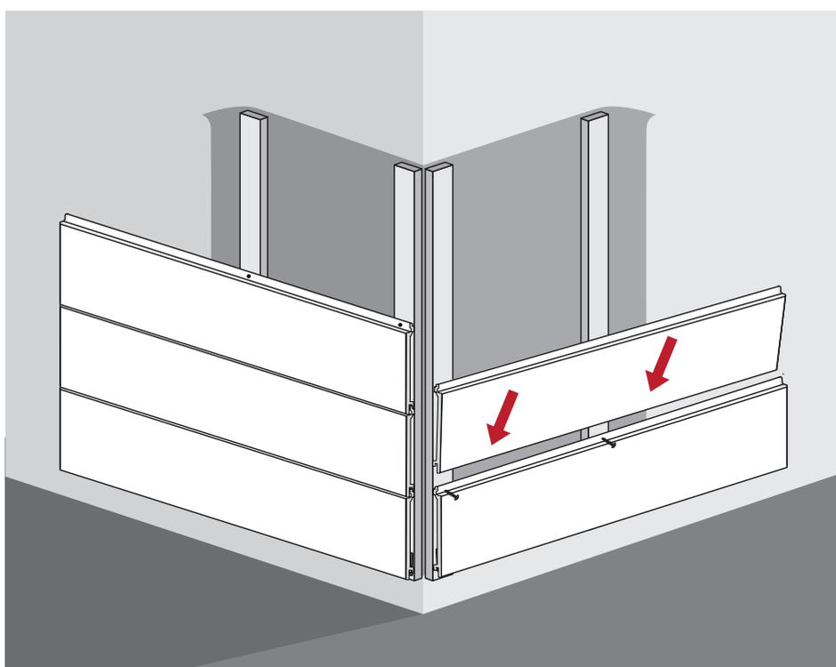
Contrôler régulièrement le niveau, des ajustements peuvent être nécessaires.
