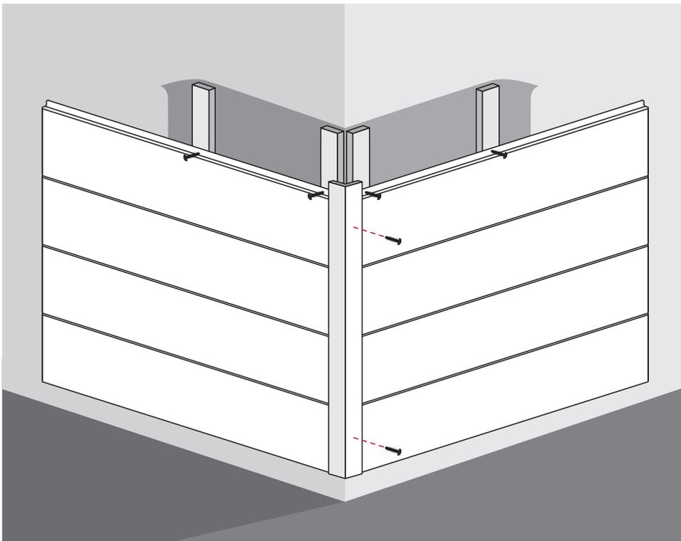
Percer et fraiser le profil composite. Fixer la cornière d'angle extérieur à l'aide de vis inox tête fraisée 3,5 x 30 mm.
