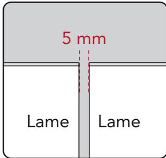
L'espace doit être de 5 mm entre les bouts de lames de bardage neowood.
