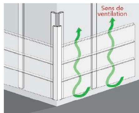
Utiliser des linteaux de bois traités de classe 3 minimum et d'une épaisseur minimum de 20 mm indispensable pour soutenir le poids des lames et permettre une ventilation suffisante sous le bardage. Respecter l'entraxe de 500 mm maximum entre chaque linteau ainsi que leur alignement. Si nécessaire, il est possible de placer une membrane d'étanchéité entre les tasseaux et le mur porteur. Protéger ensuite chaque linteau par une bande de protection Trocosto.
